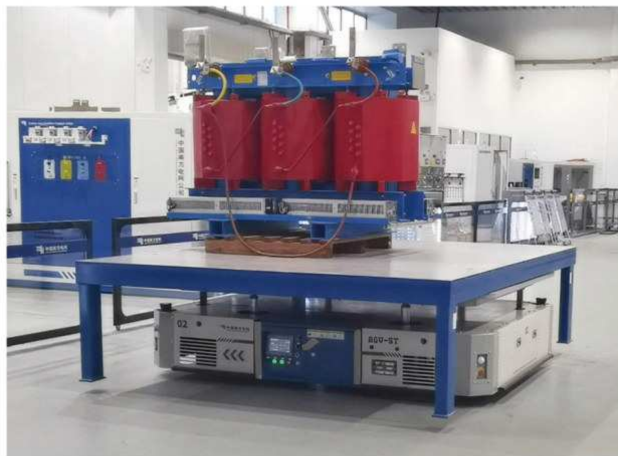
5吨激光升降称重AGV——南方电网 5 tons laser navigation AGV
